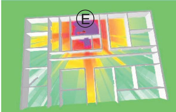
**Bild 14:** Zum Vergleich: Strahlenexposition durch ein Handy (E) mit einer Leistung von 1 W zur Aufrechterhaltung des Funkkontaktes mit der 200 m entfernten Basisstation.
